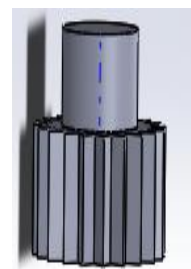
fig. 2.9.f : arbre moteur (hauteur)
